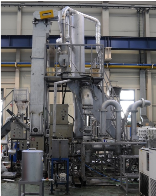
Fig. 2. Tilted-slide fast pyrolyzer
