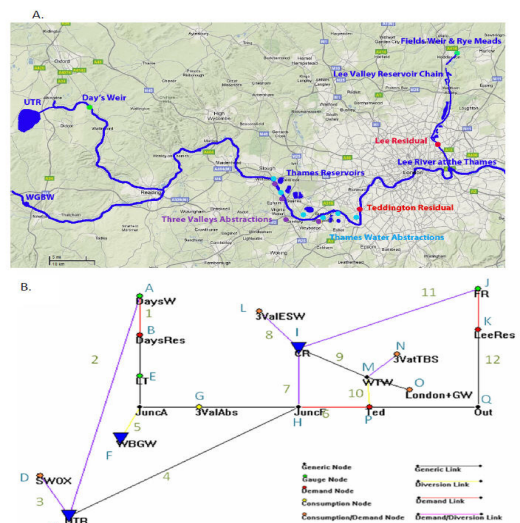
Fig. 2. 템즈강 유역과 IRAS-2010 모형의 하천/저수지의 모식도 [10]
